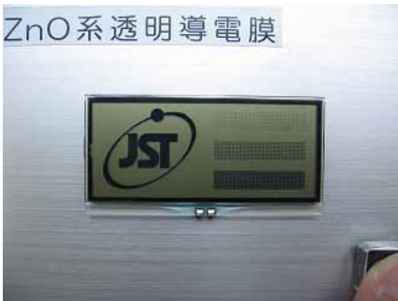
図3 ZnO 系薄膜で試作したモノクロ液晶ディスプレイ 開発したエッチング液でのパターンニングで 100 μm パターンが明瞭に確認されている。5 μm パターンも実現できている。
