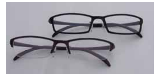
図 4 炭素繊維複合 AZ91D 材を用いて射出成形したマグネシウムフレームの眼鏡
