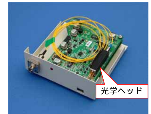
図5 SOPモニターモジュール 図4の光学ヘッドと計算用電気回路を組み合わせたもの
