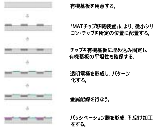
(図2) 本研究では、この図に示すように、「MATチップ移載装置」を開発して、結晶シリコン ICチップを有機基板上の画素位置に移載、埋め込み固定し、そこに配線を行なって超大画面LCD用画素制御基板を製造する。
