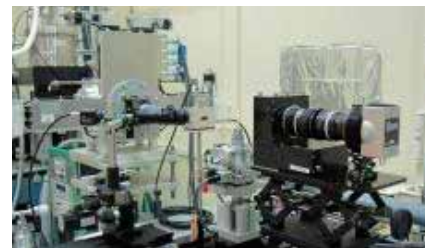
高分解能撮像による材料内部観察用 CT・イメージングシステム
