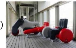
風船構造の パーソナル モビリティ 「poimo (ポイモ)」
