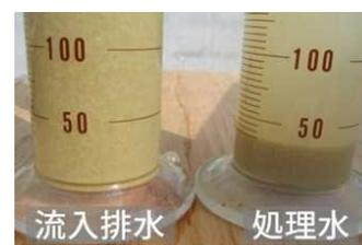
微生物による油分解処理による汚泥沈降性の改善
