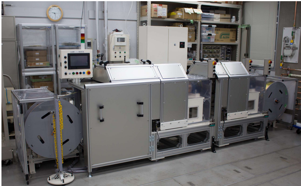
図 SCSC ケーブルと作製機
