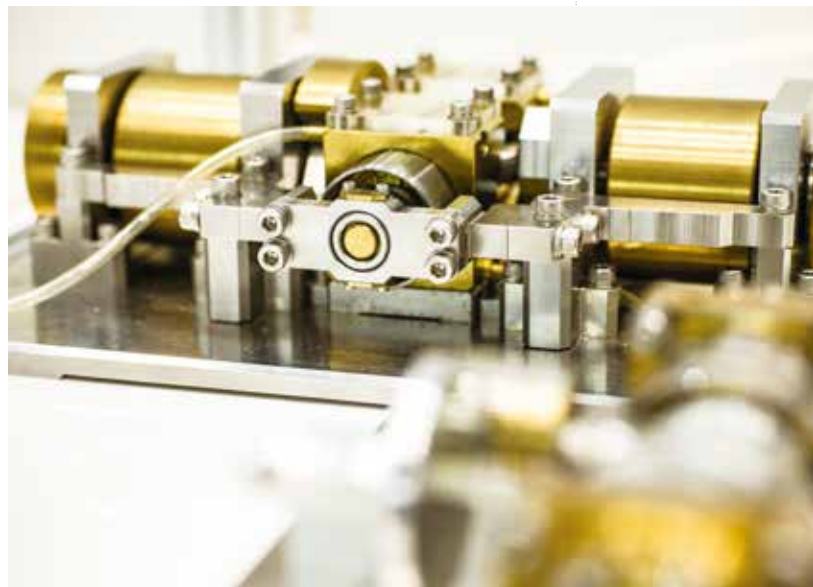
トリラテラル蒸気サイクルに用いられる無振動クロスバランスレシプロ膨張機
