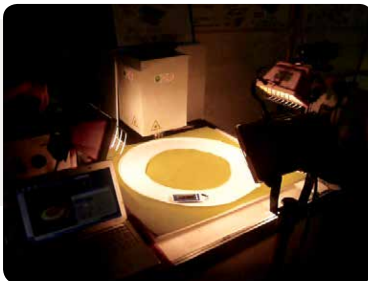
スピコート法によって塗布されているペロブスカイト膜
