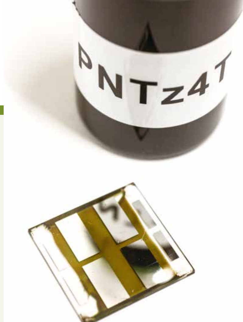
開発したポリマーインク(上) 塗布して作製した太陽電池(下)
