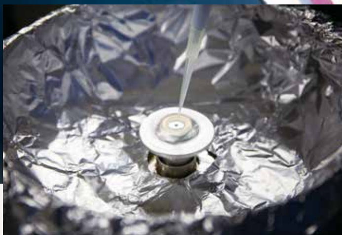
スピコート法によって塗布されているペロブスカイト膜
