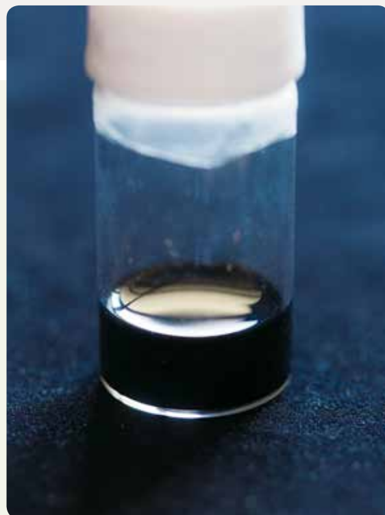
高容量を実現する正極材料(酸化ルテニウムナノシートのコロイド)
