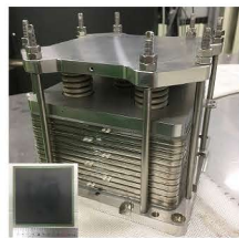
図3 単セル (120mm 角) を 10 層積層したショートスタック
