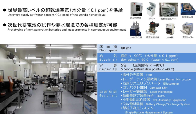
図2. スーパードライルームおよび小型試験用電池作製装置群
