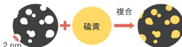
図4. ミクロ多孔性炭素に硫黄を閉じ込めた正極活物質
