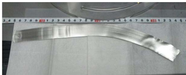
図4. 二次電池用に開発されたリチウム金属負極
