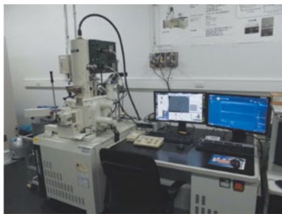
SEM(物質・材料研究機構) 50eVからの検出が可能であるため一般的に 検出不可能なLi元素が検出可能。
