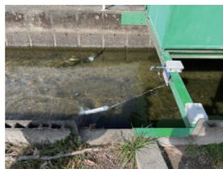
水位計測と通信系を行う水上のボックスと水中で発電と流速計測を行う流況センシングモジュール
