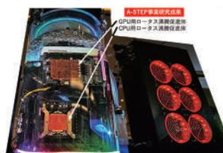
本研究開発であるロータス沸騰促進体が搭載された液浸冷却サーバー
