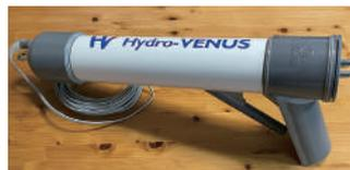
発電と流速センシングを行う流況観測モジュール外観
