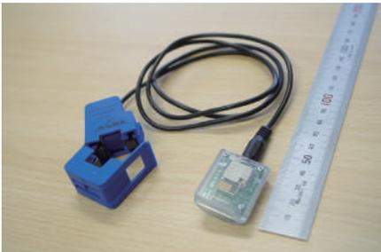
開発したセンサは、クランプ型のカレントトランスと、30mm角程度の小型で安価な信号処理回路から成る。信号処理回路に、種々のカレントトランスを組み合わせることで幅広い測定に対応する。写真は開発時のものである。
