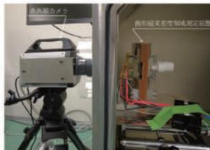
図2 熱的測定法による鉄損測定風景
