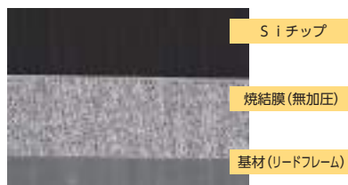
図3 銀ナノ微粒子応用例 (銀ナノ微粒子とマイクロ銀を混合しペーストを作製、250℃×60分焼結後のSEM画像 上段: Siチップ(裏面金めっき)、中段: 無加圧焼結膜、下段: 基材)
