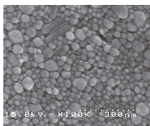
図2 銀ナノ微粒子合成例 (導入設備で合成した銀ナノ微粒子の一例)
