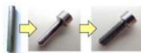
図2 開発した高強靱性チタンボルト(M4キャップボルト)
