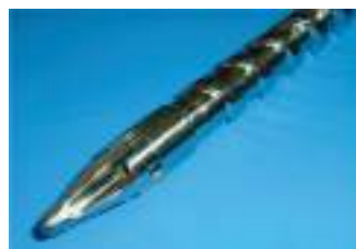
開発鋼を用いて試作した射出成形装置部材
