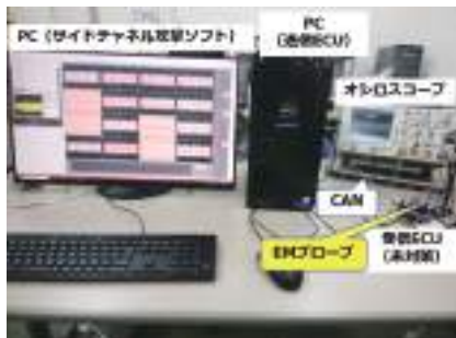
車載CAN通信におけるサイドチャネル攻撃のデモシステム：未対策LSIではMAC生成に使われる暗号鍵を数分で窃取できるのに対して、開発したHSMでは鍵窃取を防止できた。
