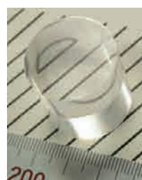
(a)原料連続投入法によるリチャージ6回育成後のルツボと (b)従来法によるリチャージ6回育成後のルツボの写真
