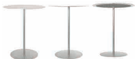
天板を横から見ると断面がわずかな円弧を描く。先端は2mm、中央は12mmの薄さの中に六角形のハニカム構造を削り出すことによって、超軽量、高剛性、機能美を実現した。
