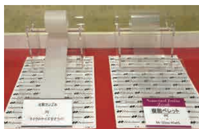
ゼオライトナノ粒子を約50wt%配合したフィルムサンプル(右)、マイクロサイズゼオライト配合フィルム(左)と比較して、高い透明性を示す。
