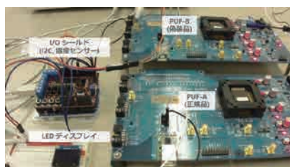
PUF技術を用いたセキュアブートシステム：正規のPUF搭載LSIのみがブート用暗号鍵を再生成できるため、悪意ある不正プログラムの実行を阻止できる。
