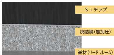
図3 銀ナノ微粒子応用例 (銀ナノ微粒子とマイクロ銀を混合ペーストを作製、250℃×60分焼結後のSEM画像 上段: Siチップ(裏面金めっき)、中段: 無加圧焼結膜、下段: 基材)
