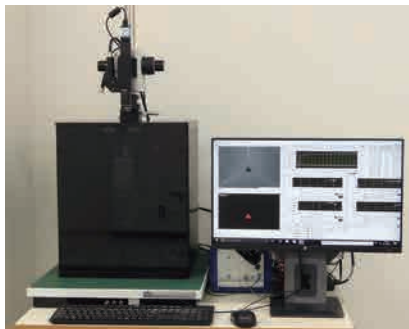
図1 顕微インデントの外観写真
