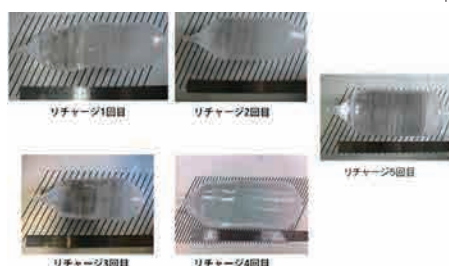
図1 チャージ5回目までに育成した結晶の様子(Φ2インチ)
