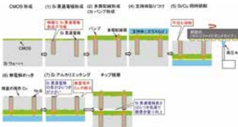
図1 低汚染で高平坦なSi貫通電極ウェーハ薄層化プロセスフロー図。
