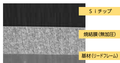
図3 銀ナノ微粒子応用例 (銀ナノ微粒子とミクロ銀を混合ペーストを作製、250℃×60分焼結後のSEM画像 上段:Siチップ(裏面金めっき)、中段:無加圧焼結膜、下段:基材)
