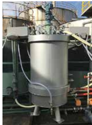
パイロットスケールの連続回分処理装置(処理能力:1m 3 /日)
