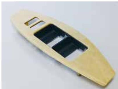
突き板インサート成形(射出プレスモード)による試作品
