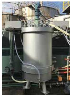
パイロットスケールの連続回分処理装置 (処理能力: 1m<sup>3</sup>/日)
