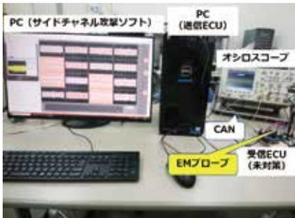
車載CAN通信におけるサイドチャンネル攻撃のデモシステム：未対策LSIではMAC生成の暗号鍵が数分で窃取できた一方、開発したHSMでは鍵窃取に失敗した。
