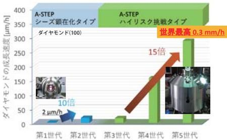
図1 開発したアリオス製マイクロ波プラズマCVD装置とダイヤモンド(100)膜の成長速度の推移
