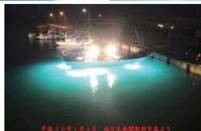
600W船上灯(左上)、1KW水中灯(右上)、漁船搭載(下)
