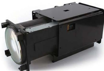
今回試作したカメラモジュールの外観
