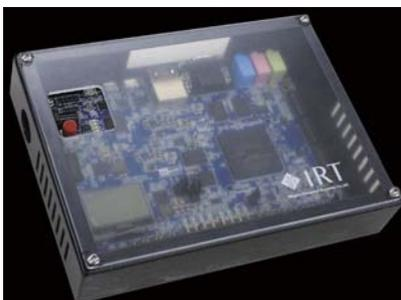
写真2 SOP(全文検索専用デバイス)
