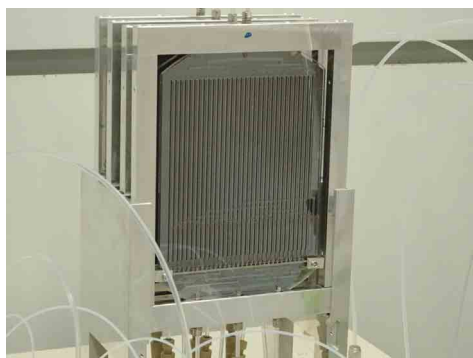
シリコンにより除熱を強化したリアクターの4並列運転
