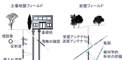
基礎杭の有無・位置・杭底深度を指向性アンテナにて3次元位置として特定可能。
