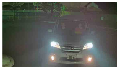
ダイナミックレンジによるヘッドライトの飽和を抑え、搭乗者まで認識
