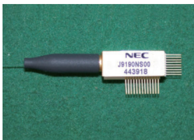
開発した超小型狭線幅波長可変レーザ
