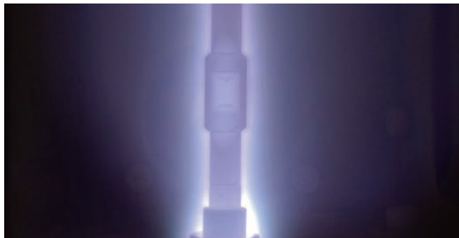
開発した高密度プラズマによるDLC成膜中のワーク
