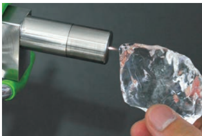
零下から高温までのプラズマを生成できる 温度制御プラズマジェット
