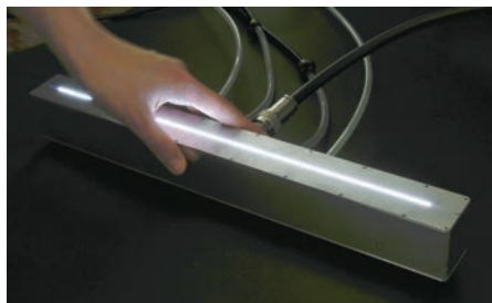
12インチ対応の表面処理用リニア型プラズマ装置
