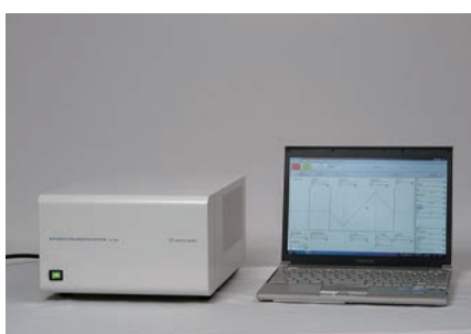
写真1 電池特性評価用in-situ マルチインピーダンス測定システム
