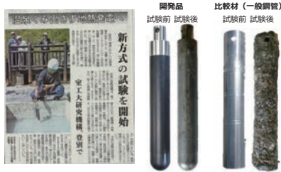
図2 耐環境・長寿命セラミックス複合材料2重鋼管の温泉水侵食試験
