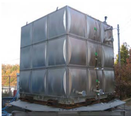
実機受水槽の振動実験
