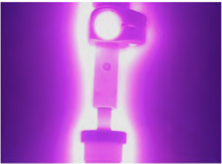
図2.高速成膜中のしゅう動部品
