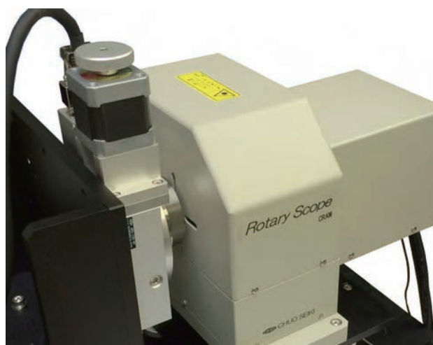
2次試作機による回転ステージの測定
