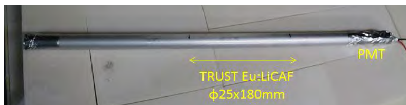
製作した1インチ管形状の透明樹脂型Eu:LiCaAlF 6 シンチレーター中性子検出器とその信号波高分布
