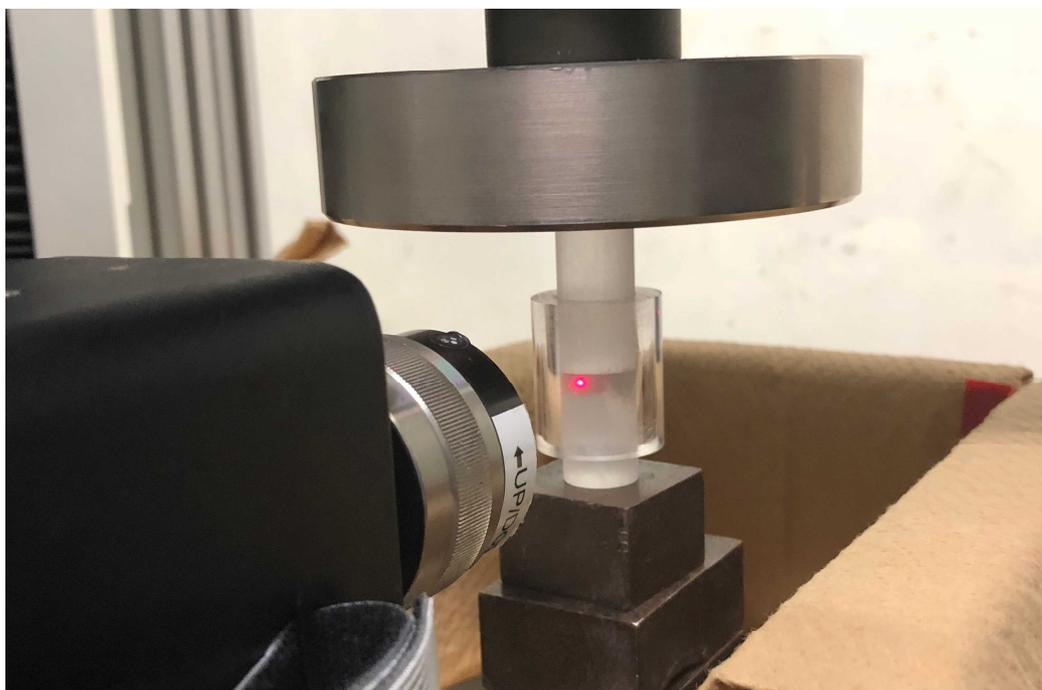
図 3-7 透明成形型を用いて行った乾式成形過程の OCT 観察の様子
