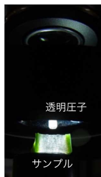
ソフトマターの顕微インデンテーション結果と解析結果
