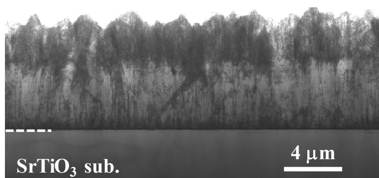
図 4-(2)-16 TEM による(100)KNN の配向体の断面観察像.
