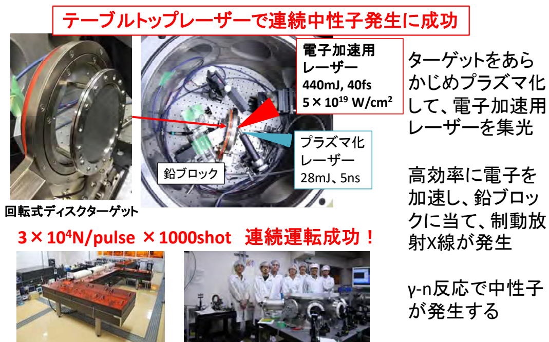
図2: 高繰り返しテーブルトップレーザーによる光核反応中性子発生試験
