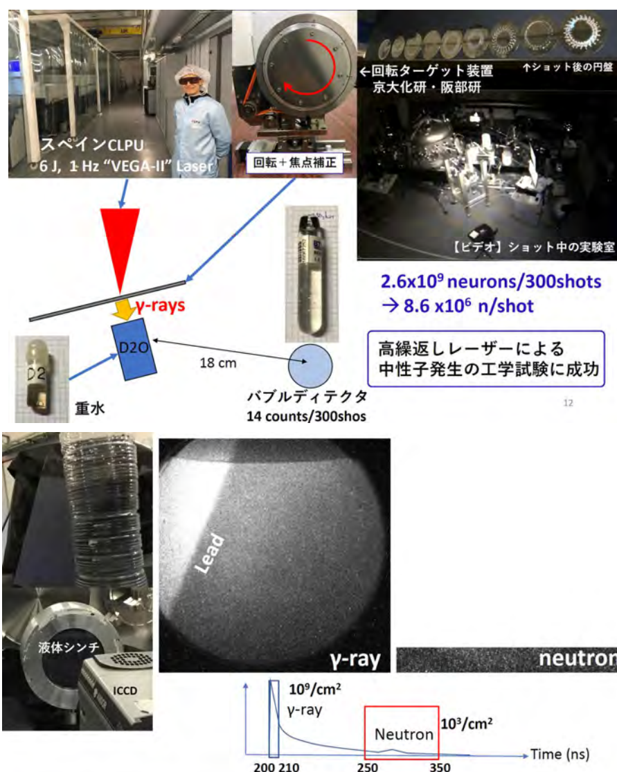
図3: スペインの CLPU 研究所における光核反応中性子発生試験
