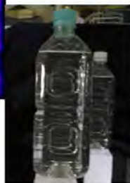
図22: 高速中性子ラジオグラフィの結果 PET ボトル中の水 手前に置いた水の影の幅の方が広く、中性子源の空間ポイント性による拡大撮像となっている。
