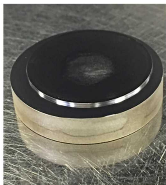
接合されたBe - V 試料. Ar-FAB 衝撃 2kV, 20mA, 5min. 手で振る程度では剥離しないことを確認。
