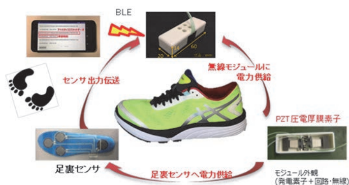
図 2 プロトタイプスマートシューズの構成
