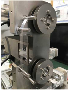
図 1, 二重ターゲット駆動装置
