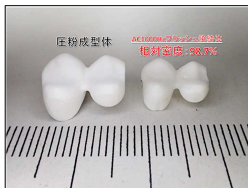
図 18 人工歯形状に成型された圧粉体を用いて交流電界 1000Hz においてフラッシュ焼結を実施した例
