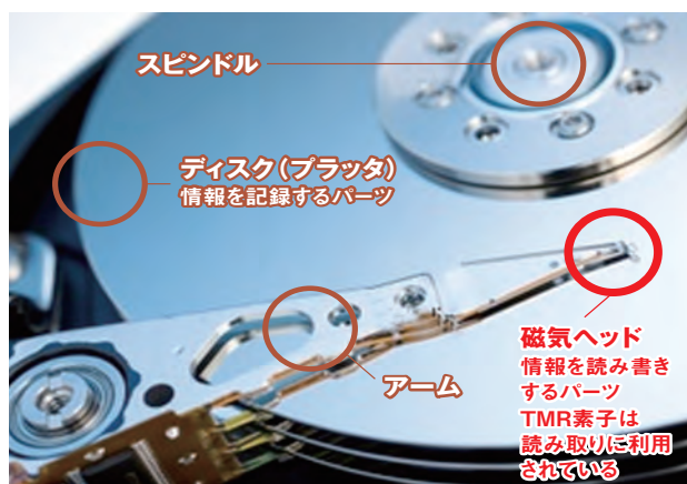
さきがけ「ナノと物性」で大容量化を実現したハードディスクの内部構造 提供：湯浅新治 産業技術総合研究所 ナノスピントロニクス研究センター長
