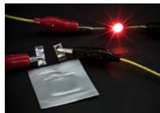
試作した硫化物型全固体電池でLEDを点灯（写真提供：全固体電池チーム）
