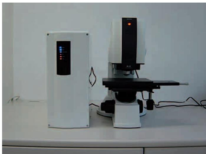
(応用品) 3次元光学走査計測装置
