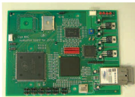
試作JSTEPチップ評価基板
