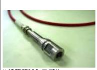
X 線管部試作モデル
