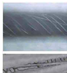
高精度X線CTとデジタルマイクロスコブによる層内破壊き裂先端近傍の繊維・樹脂損傷の解析結果
