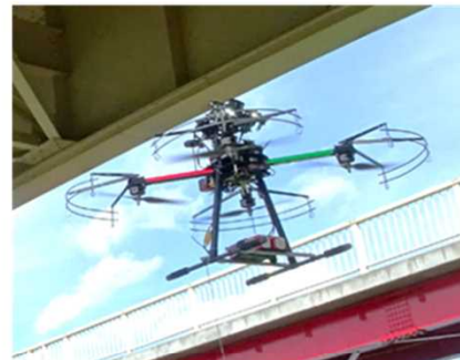
▲橋梁の損傷写真を撮影する技術
