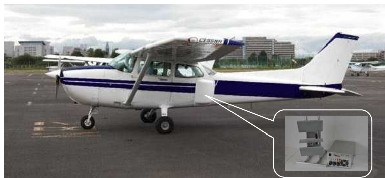
アルウエットテクノロジー社製合成開口レーダ(ATSSAR)搭載航空機
