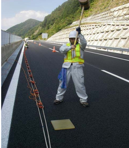
ランドストリーマによる探査の様子
