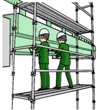
従来型橋梁近接目視点検
