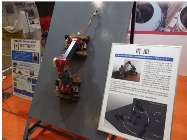
図9 一対のIMマグネットを用いたクローラ壁面移動ロボット
