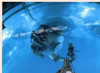
遊泳型探傷装置 (1990)
