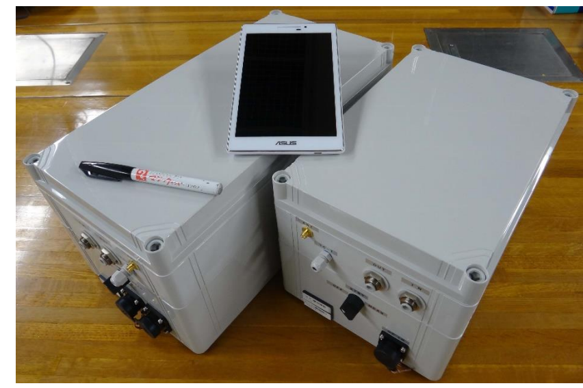
高機能型の火山ガスの多成分組成の自動計測・データ伝送装置(左)および無人機設置用の簡易型装置(右)
