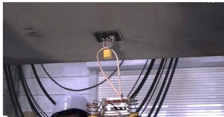
コンクリート壁面に対して接着力1kgfを実証
