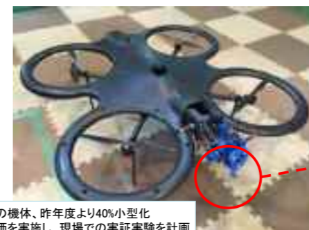
改良中の打音点検飛行ロボットシステム
