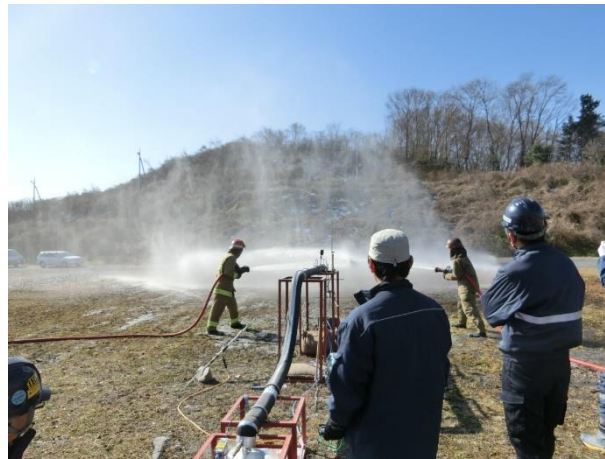
図5. 射水による水素ガス火災の消火実験
