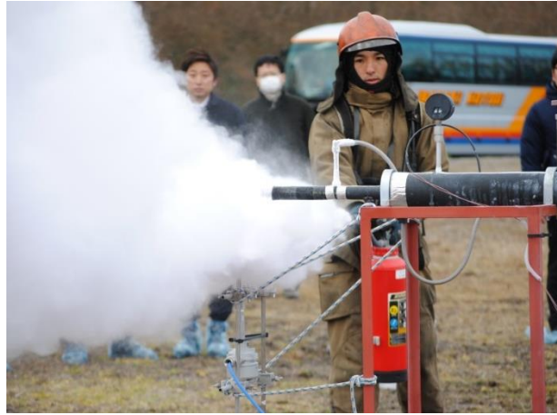
図4. 粉末消火器による水素ガス火災の消火実験
