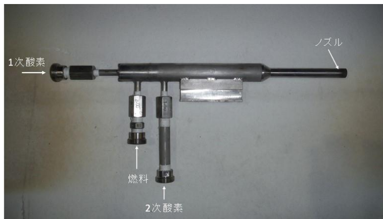
図 23 脱脂バーナの外観写真
