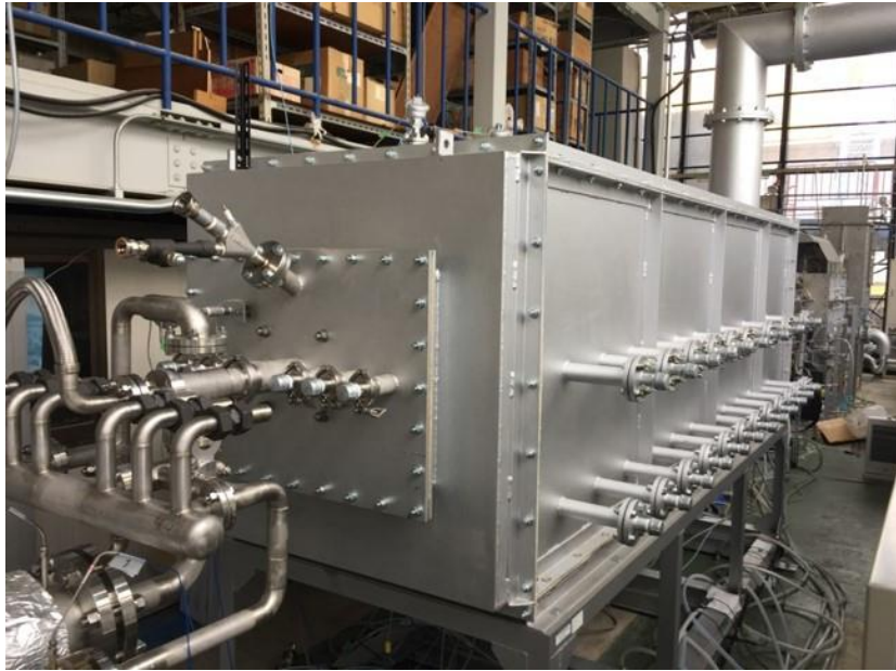
図 10 100kW モデル燃焼炉の外観写真
