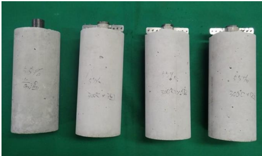
図 3.23 サンプル試験材外観(左より、非加熱、3 回昇温後、6 回昇温後、12 回昇温後)
