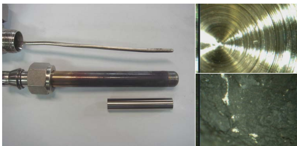
図-7 SUS反応管とニッケル内筒管 (内筒管底部: 写真右上、反応後内筒管底部: 写真右下)
