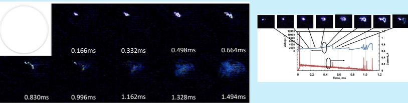
光ファイバ組込型点火プラグによる時系列分光計測
