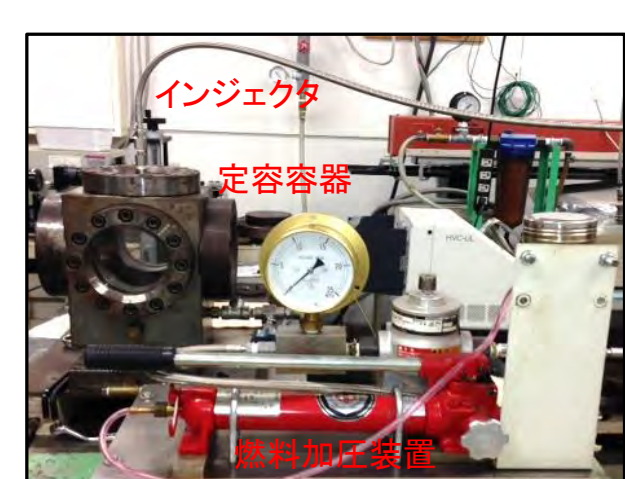
図1 定容容器実験装置 (Max:20MPa)
