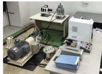
燃料噴射系・制御系・定容容器・カメラ設置状況
